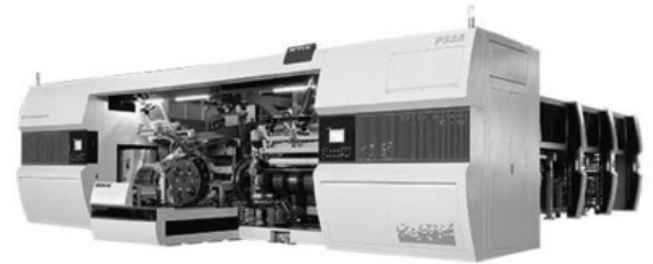
图 3 PS2A 半钢一次法成型机
