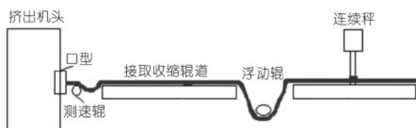
图 2 常规挤出生产线增加测速装置图
