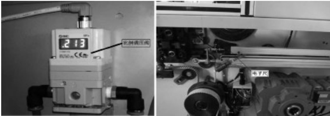
图3 压臂上加电子尺和比例调压阀形成锥度控制
