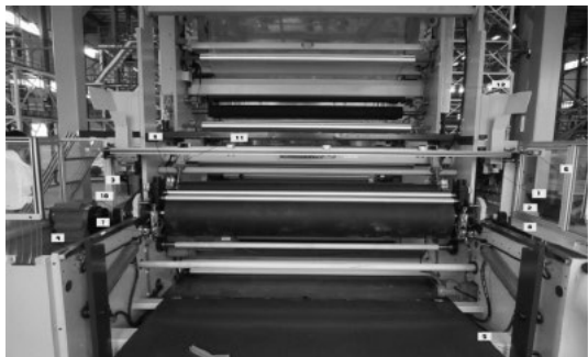
1—上芯轴检测; 2—旋臂升到位; 3—旋臂降到位; 4—卸卷芯轴检测; 5—卸卷升/降到位; 6—拉绳开关; 7—左气嘴进到位; 8—右气嘴进到位; 9—预加速气缸; 10—光电眼; 11—压辊气缸; 12—计米
