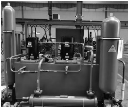
图3 密炼机伺服电机液压系统实物图片
