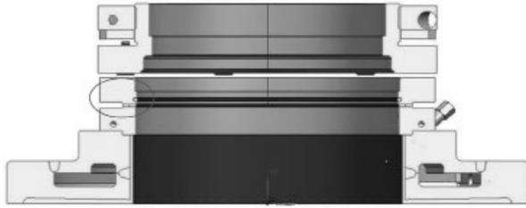
图 10 外压式机械密封装配示意图
