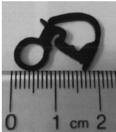
图 1 标准天窗防风雨密封件 (涂有 ARC-13/P5-UV-HSLV+ 材料, 零件 B7) 的横截面
