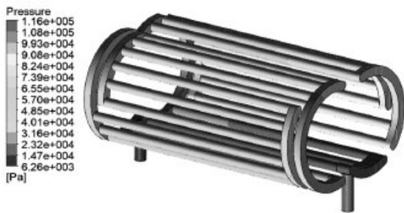
图8 流道压力分布云图
