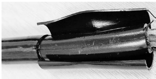
图2 尼龙护套和聚乙烯护套不黏黏
