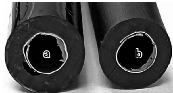
图11 双层护套和单层护套横截面图
