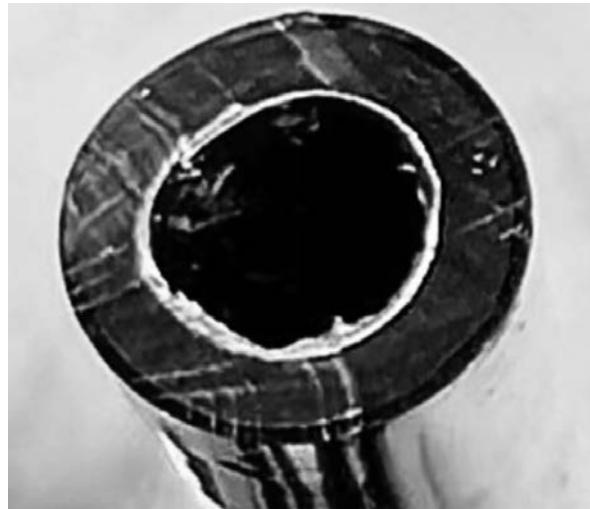
图 13 黏结型聚乙烯和尼龙一次共挤光缆护套
